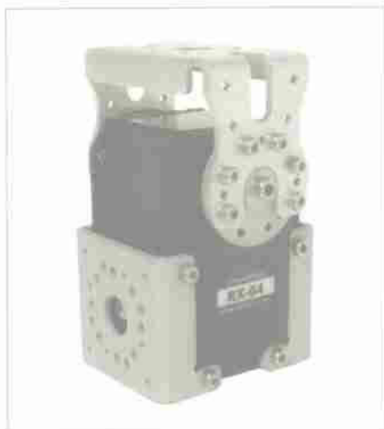
Obr. 1. Pohon Dynamixel RX-64 opatřený spojovacími prvky (kovovými)
